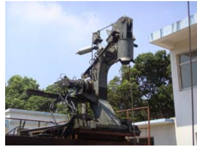
单吊点波浪补偿吊机在工作台上图片
