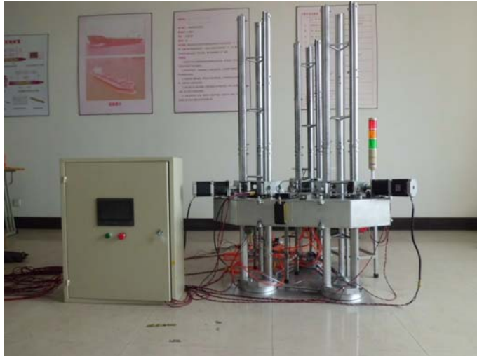
175m 水深自升式钻井平台物理样机模型
