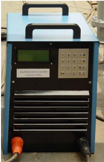
装备用智能化软开关式逆变焊机
