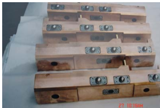
铁路钢轨对焊铜合金电极
