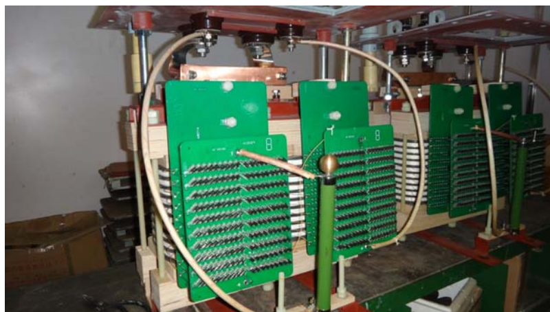
电除尘用高频整流变压器器身
