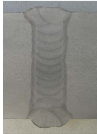
图4 窄间隙焊缝实例（板厚 50mm）
